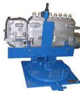
**14 500****Стенд для разборки-сборки ТНВД типа УТН (трактор)**
