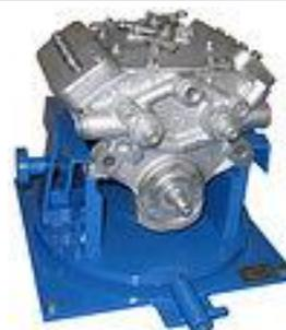
**13 500****Стенд для разборки-сборки ТНВД МАЗ(ЯЗТА)**
