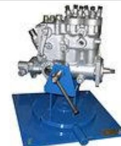
**13 500****Стенд для разборки-сборки ТНВД типа 175, 185**
